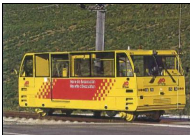
Ce véhicule réversible permet d'évacuer 50 passagers en position debout ou des victimes sur des brancards
