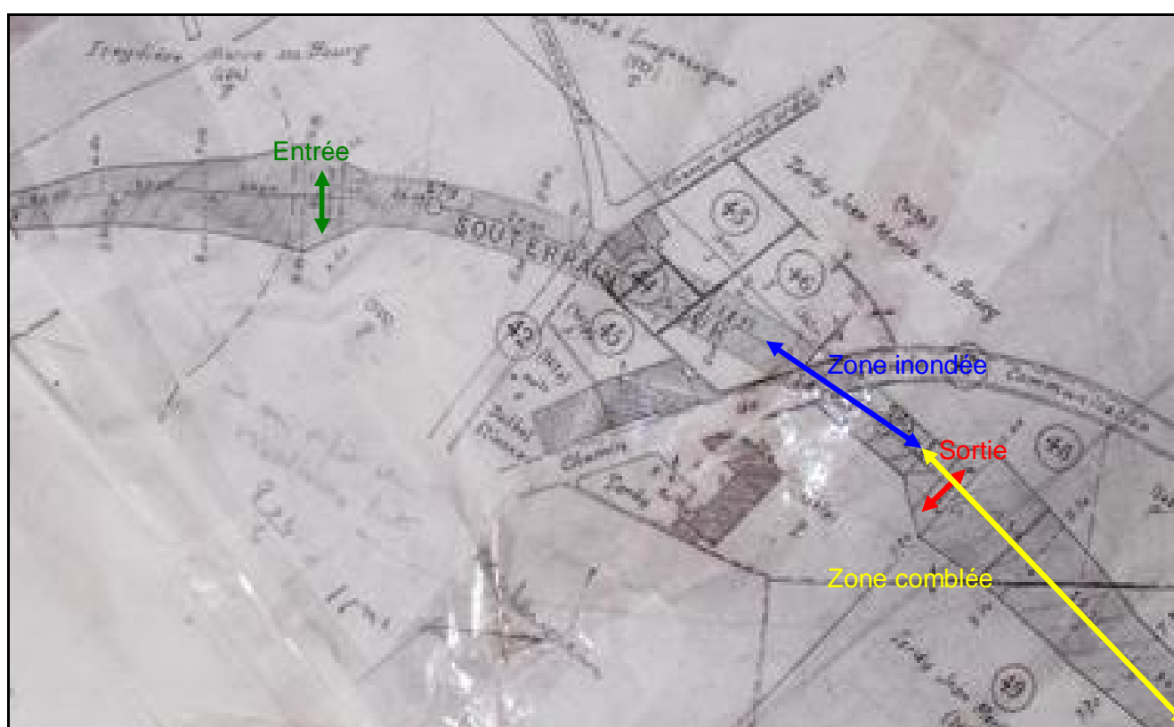
Plan d'époque du tunnel de Longessaigne avec surcharges faisant apparaître les zones inondée et comblée Sur les 140 m de sa longueur initiale, le souterrain peut être aujourd'hui emprunté sur environ 80 m
