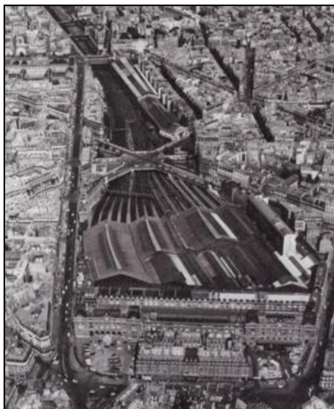
Vue aérienne actuelle de la place de l'Europe et de sa galerie En raison de sa forme particulière en X, la longueur au-dessus des voies varie de 48 à 95 m.
