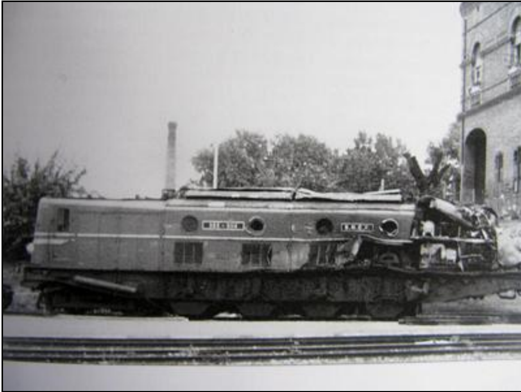
La locomotive 2D2 du train tamponneur raccourcie d'un quart de sa longueur
