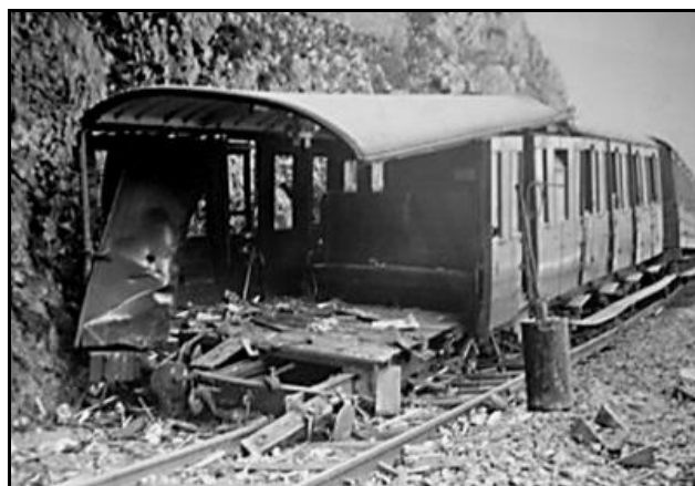
Des voitures encastées les unes dans les autres à la sortie du tunnel
