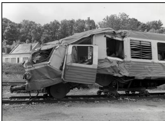
Ci-dessus et ci-dessous, l'état du matériel après extraction du tunnel montre bien la violence du choc
