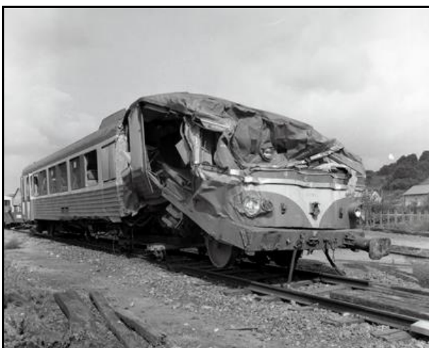
Ci-dessus et ci-dessous, l'état du matériel après extraction du tunnel montre bien la violence du choc
