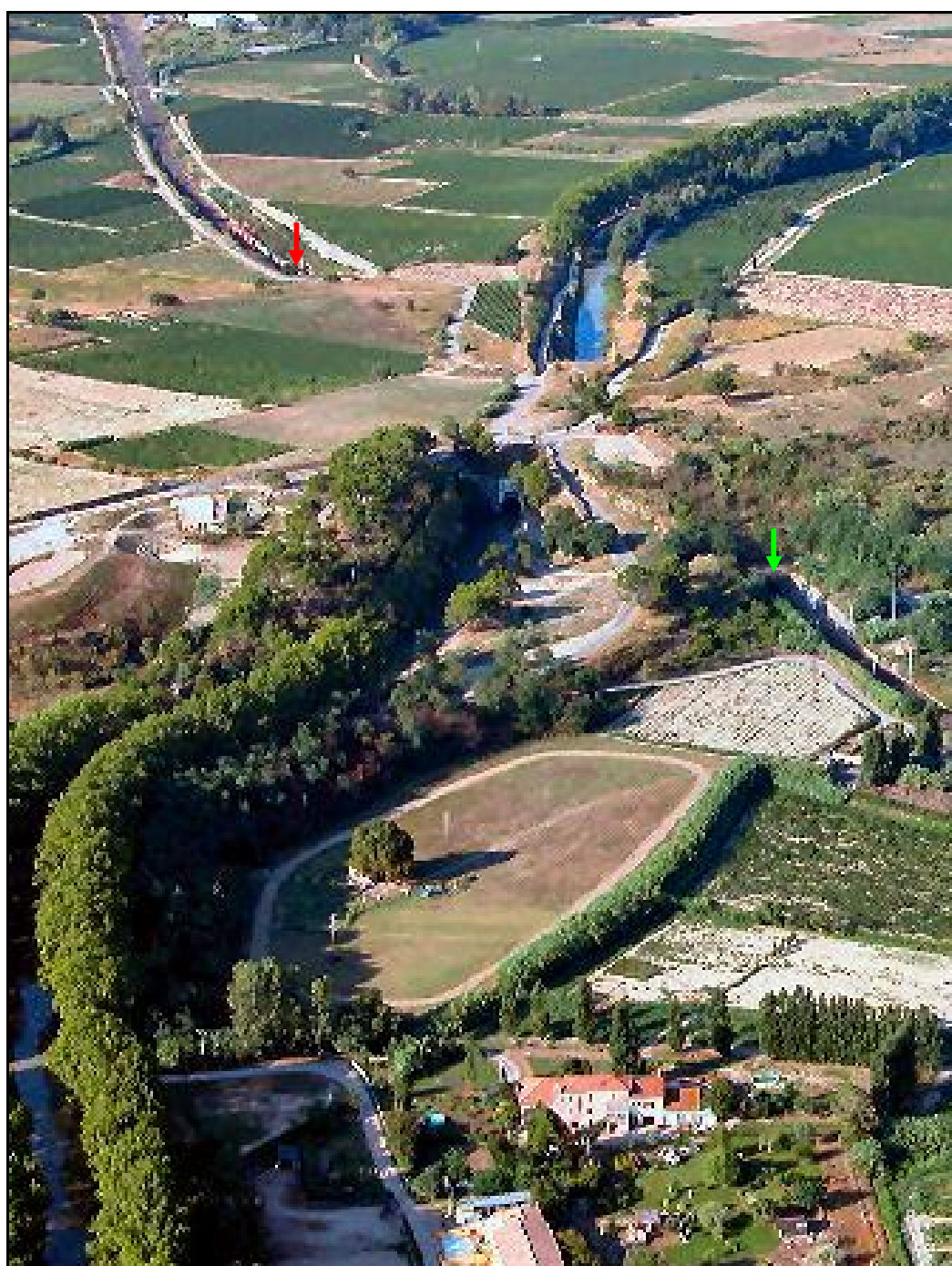
Jolie vue aérienne montrant le croisement souterrain du canal du Midi et de la ligne ferroviaire La flèche verte indique la position de l'entrée. La flèche rouge indique la sortie.
