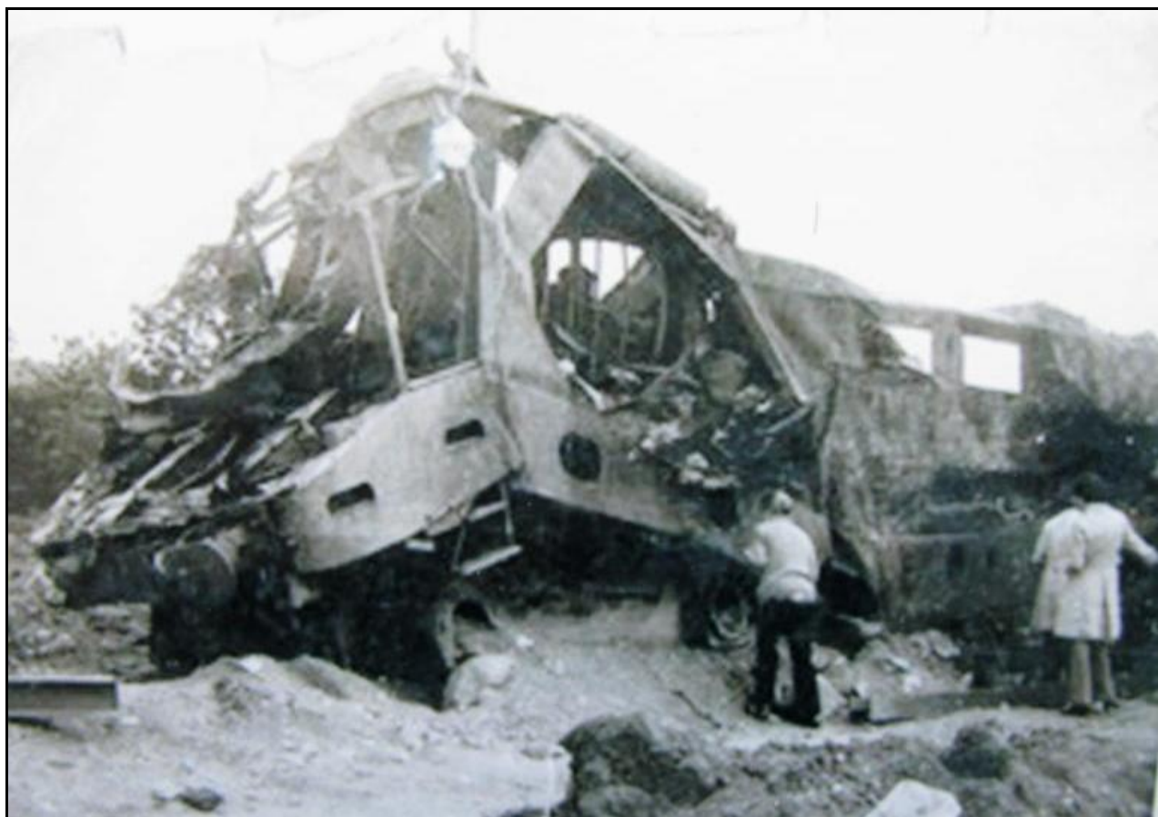
L'avant de la locomotive, châssis brisé et cabine broyée
