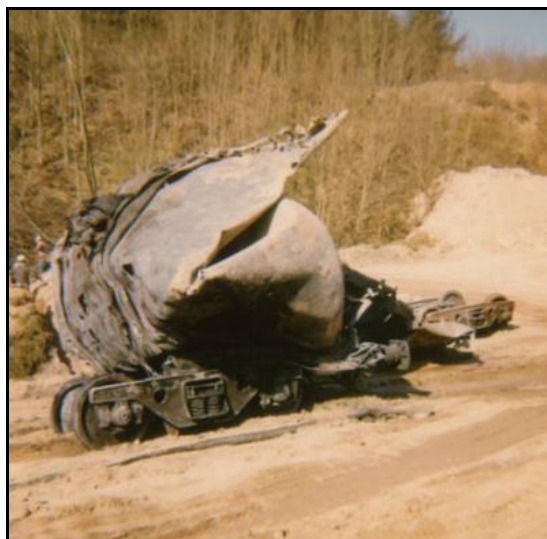
Les restes calcinés d'une citerne
