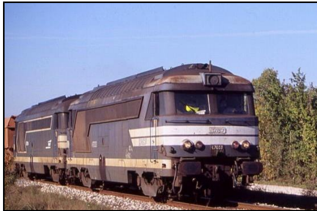
Locomotives BB 67 000, en fin de service, avec cabines renforcées La différence extérieure est assez peu visible par rapport au modèle initial
