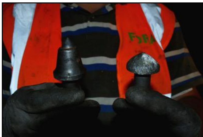
Gros plan sur deux dents de la haveuse, avant et après usage La durée de vie moyenne d'une dent pour passer d'un état à l'autre est d'environ 45 minutes C'est dire qu'il faut prévoir une certaine réserve
