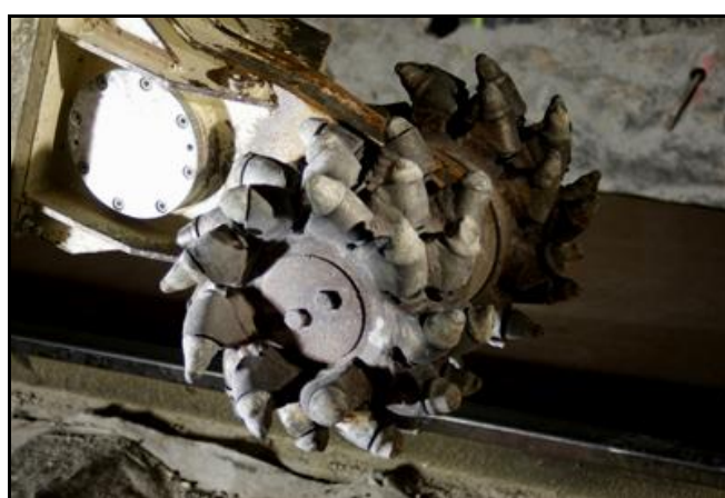
Rescindement des piédroits à la haveuse rotative Sur la photo de gauche, la bande travail, 5 x 2 m, marquée en jaune est bien visible Sur la photo de droite, noter l'usure de certaines dents qui sont carrément cassées
