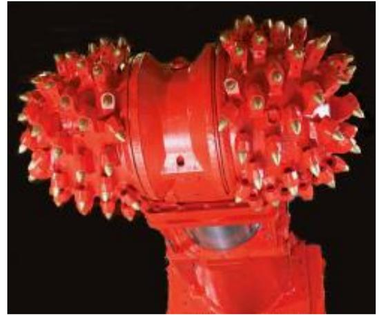
Ci-dessus et ci-dessous, la machine pour abaisser le radier et sa tête d'attaque
