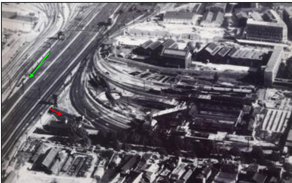
Autre vue aérienne montrant l'entrée du saut de mouton (flèche verte) et sa sortie sud (flèche rouge)
